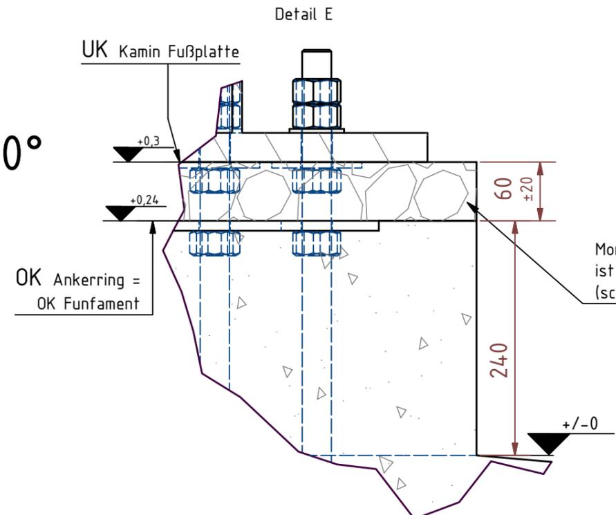
Einbauanleitung für Ankerkörbe
